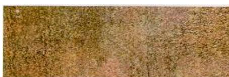
针枪等。机械工具处理后的表面要立即用吸尘器、压缩空气和毛刷清理。最终处理的表面要达到 St3 级。如下图：
