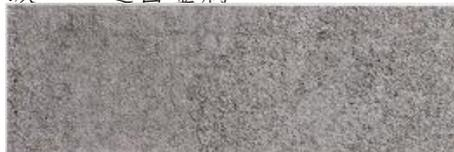
喷丸后金属表面的氧化皮、铁锈和其他污物被彻底清除，仅能看见点状或线状痕迹。然后立即用吸尘器或高压空气吹扫。喷丸用的材料为球状粒子。原则上砂子因含有二氧化硅对人体有害不应该使用。（但考虑到国内企业现状，此条不强制）喷丸后金属表面的粗糙度应该为 30 微米到 50 微米，这样可以保证漆层具有良好的附着力。
